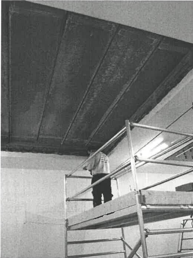
Foto 2. Undersiden av prøvedekket sett fra klangrommet
